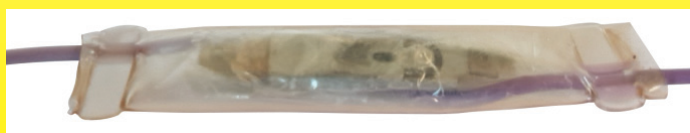
Ограничитель температуры нагревательного одеяла с медленным разрывом, используется в сочетании с английской системой управления мощностью производства GEC (General Electric Company). Он покрыт водонепроницаемой PVC втулкой, приваренной к проводам. Около 1970 года (Коллекция Ultiheat)
