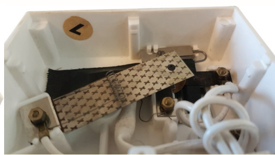
1970 г. Настройка мощности GEC (General Electric, Англия) на английском нагревательном одеяле. Предполагаемое сопротивление четко видно над биметаллическим и медленным прерывателем (коллекция Ultimheat).
