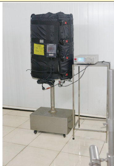
Измерение сопротивления изоляции после испытаний IPx6
