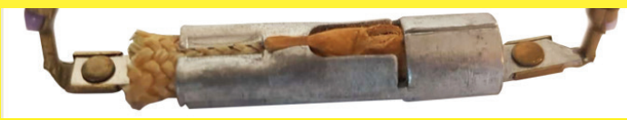
Ограничитель температуры нагревательного одеяла с медленным разрывом, используется в сочетании с английской системой управления мощностью производства GEC (General Electric Company). Он покрыт водонепроницаемой PVC втулкой, приваренной к проводам. Около 1970 года (Коллекция Ultiheat)
