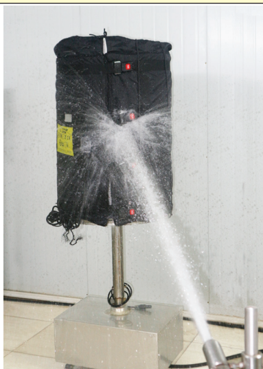
Испытание нагревателей рубашки на степень защиты IPx6
