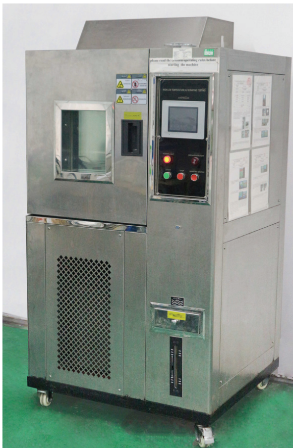
Климатическая камера, с диапазоном регулировки температуры от -90 до +150°C, диапазон регулировки относительной влажности от 1 до 100%
