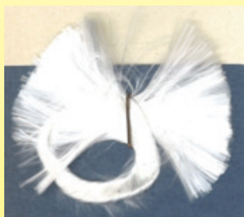
Пучки нитей стеклянной нити, образующие единый провод (Производство стеклянной нити, около 1960 года, урок в текстильной школе Вербье в Бельгии, музей Ultimheat)
