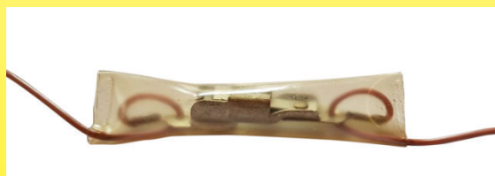
Ограничитель температуры нагревательного одеяла Calor с медленным разрывом, откалиброванный на 80°C (около 1960 г.). Обратите внимание на водонепроницаемую PVC втулку, приваренную к проводам, и петлю, сделанную электрическими проводами, проходящими через отверстие в каждой клемме - это сделано для устранения растягивающих напряжений на проводах (коллекция Ultiheat)
